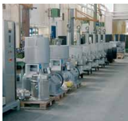
Пресс-гранулятор, типа 39-1000 высокой производительности
