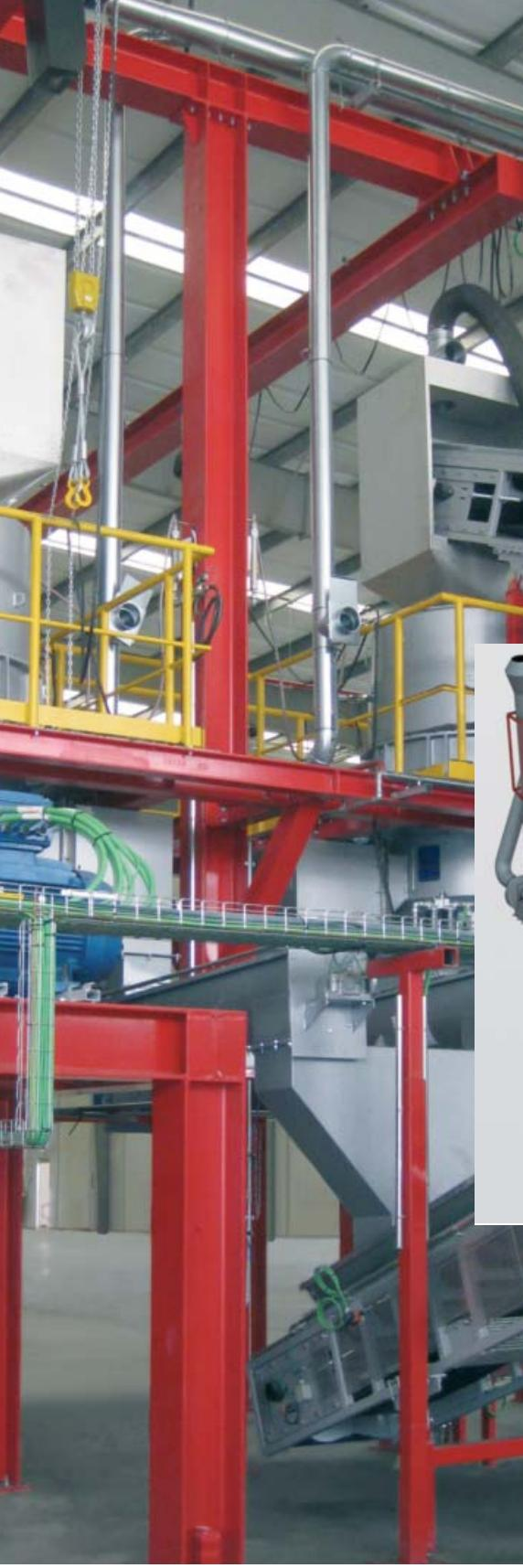
Концепт установки включает 4 основные технологические операции. При этом переработка использованных покрышек (например, 70% покрышки от легковых автомобилей и 30% покрышки от грузовых автомобилей) в стандартном исполнении рассчитана на производительность 2,5т/ч по сырью. При 3-х сменной работе это дает переработку прибл.15.000 т/год.
