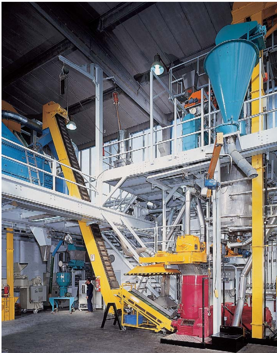
Опытная установка с дозированием, смесителем непрерывного действия, гидротермическим реактором, экспандером с кольцевым зазором, экструдером OEE, прессом с плоской матрицей, ленточной сушилкой/охладителем, установкой «Ротоспрей», валковым измельчителем.
