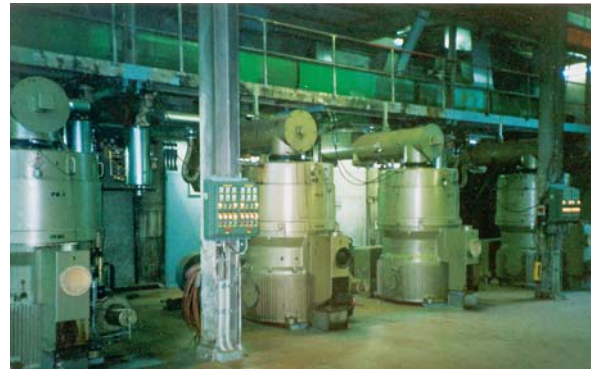
Линия гранулирования с 4 прессами
